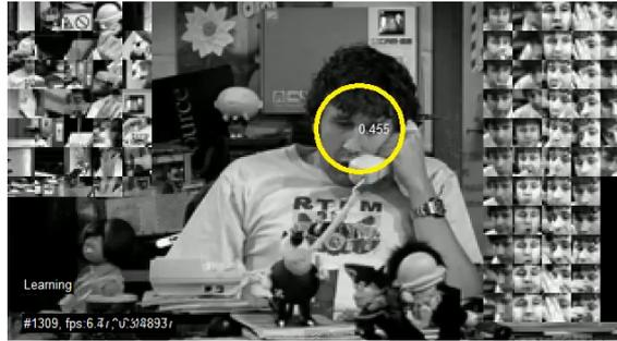
**Figura 2.13.:** Tracking de cara con OpenTLD.
