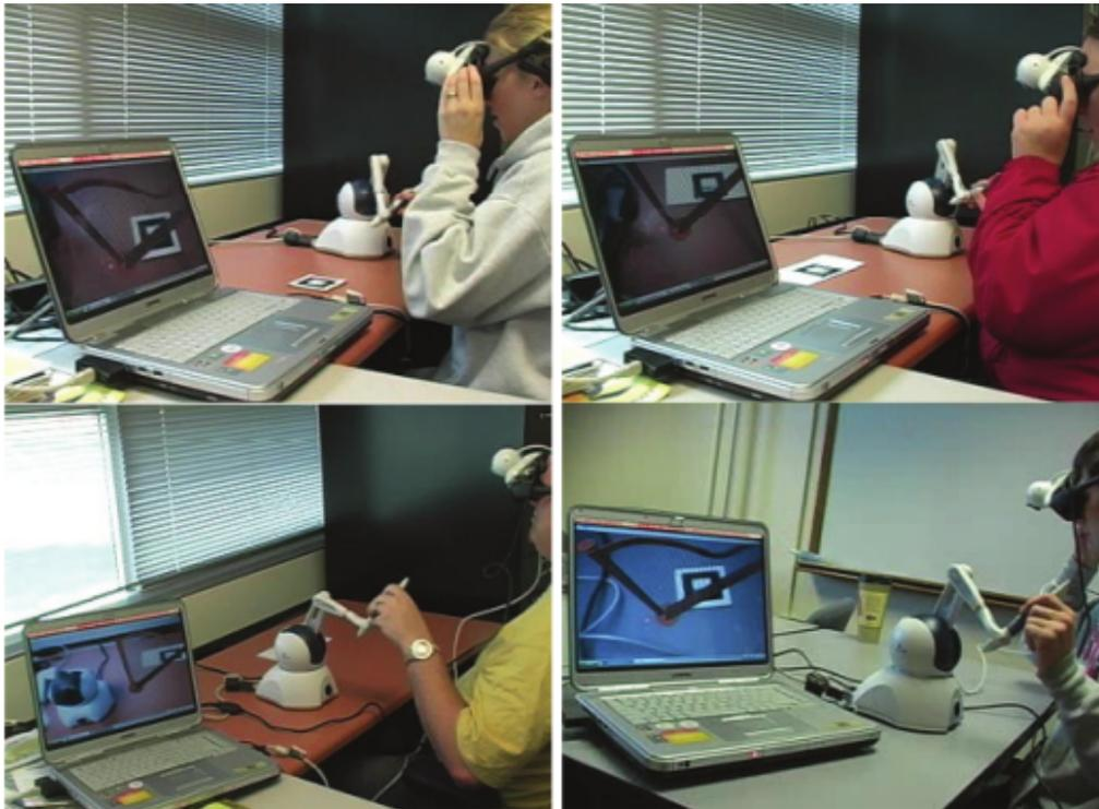
**Figura 1.2.:** Virtual Harp usado por pacientes. Se aprecia el uso de HDM, Phantom Omni y la marca de ARToolKit.
